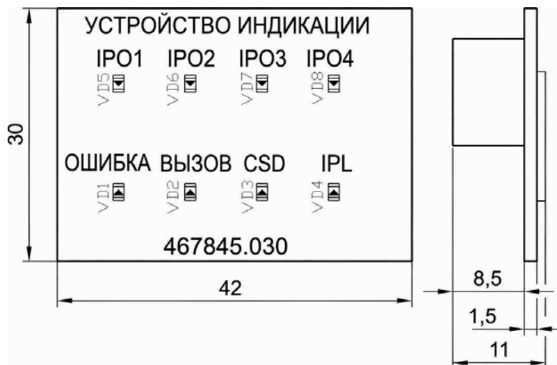
Рисунок А.5 - Габаритный чертеж и установочные размеры устройства индикации технологического
