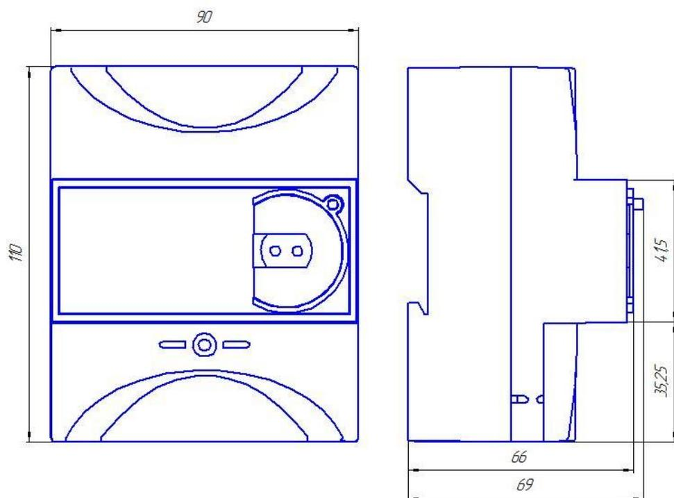
Рисунок А.1 – Габаритный чертеж и установочные размеры счетчиков МАЯК 101АРТД
