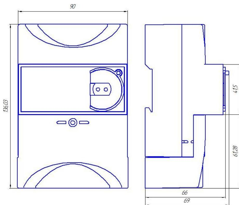
Рисунок А.2 – Габаритный чертеж и установочные размеры счетчиков МАЯК 101АРТД с крышкой МНЯК.731323.008.
