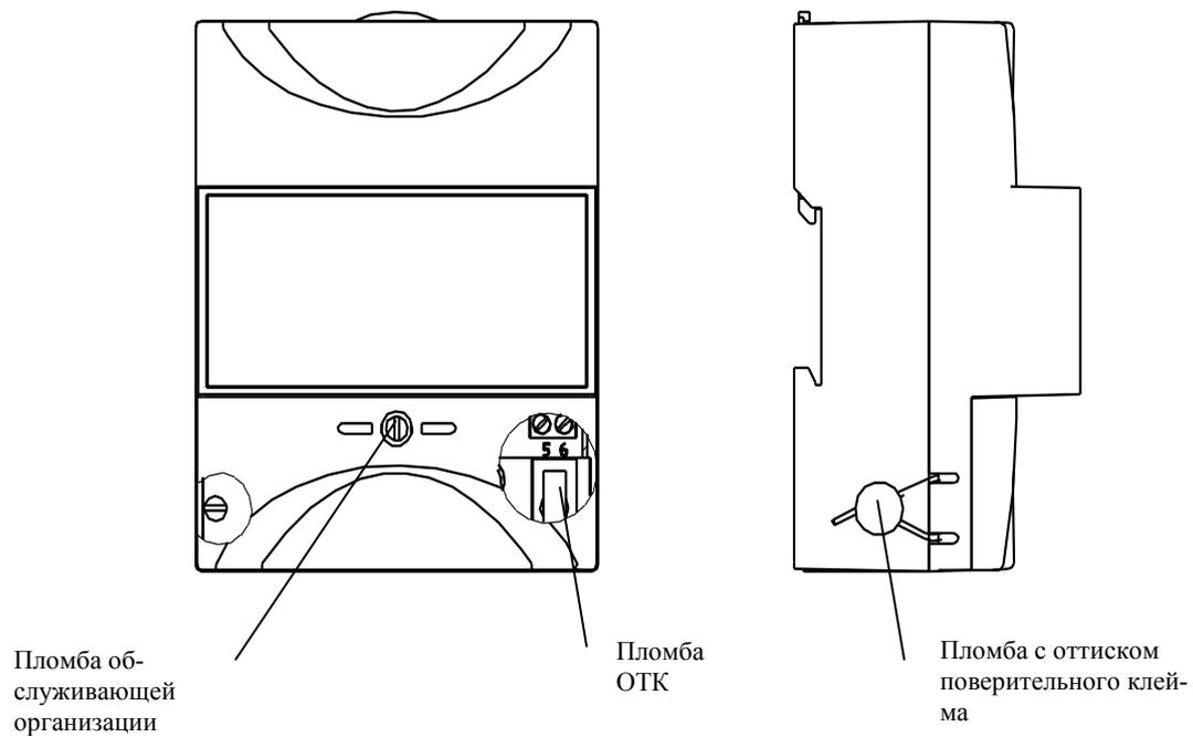
Рисунок 4 – Пломбирование счётчика
