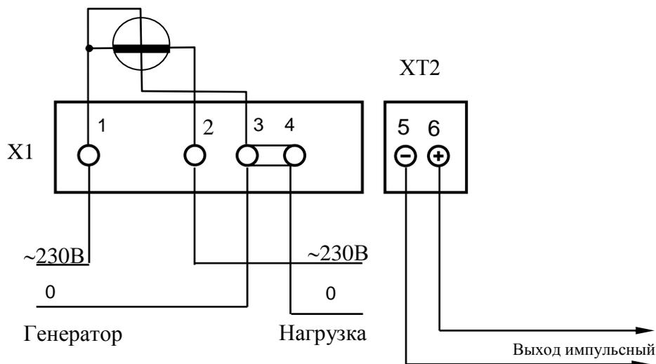
Рисунок Б.1– Схема подключения счетчиков МАЯК 101АРТД к установке УАПС-1МГ
