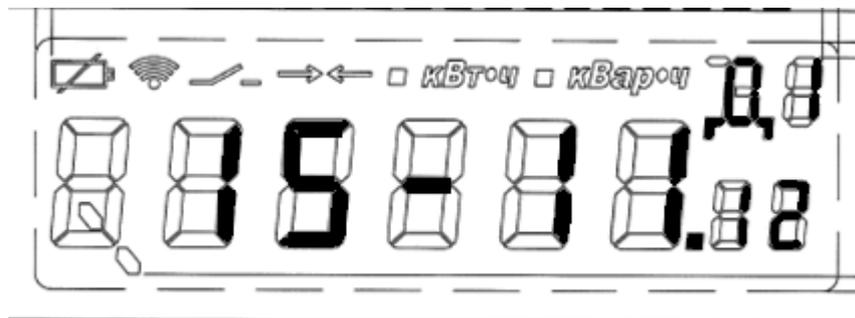
Рисунок 3 – пример отображения даты на дисплее счетчика.
