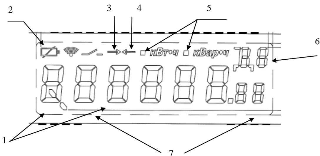
1. Индикация буквенного обозначения измеряемого параметра (P, Q, S, U, I, F, COS, TAN)
