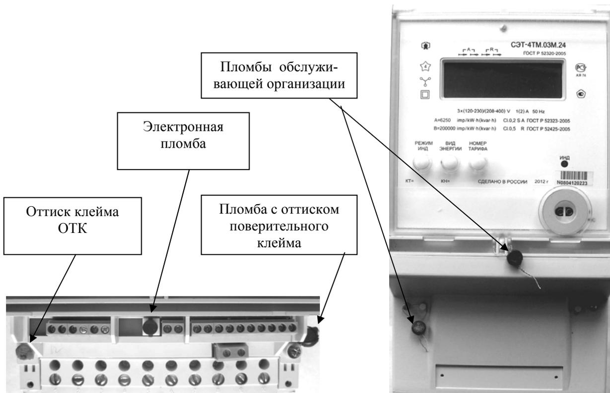
Рисунок 1 – Внешний вид счетчика и схема пломбирования
