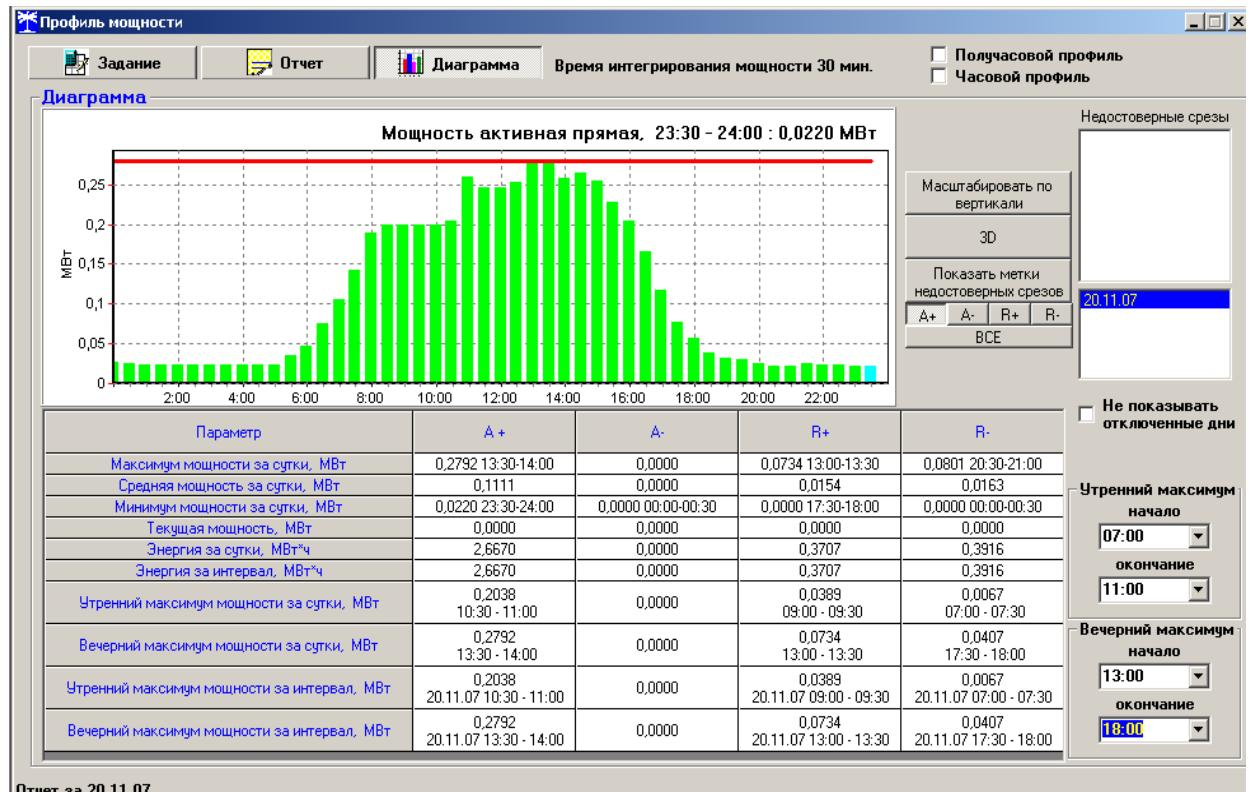
Рисунок 18 – Форма «Профиль мощности» вкладка «Диаграмма»
