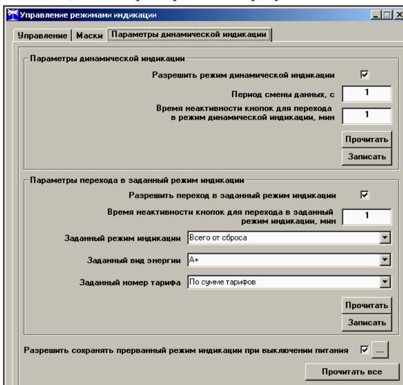
Рисунок 24 - Форма «Управление режимами индикации» вкладка «Параметры динамической индикации»
