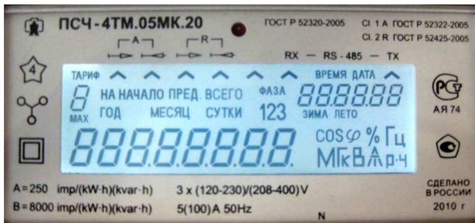
Рисунок 5 – Внешний вид ЖКИ с включенными элементами индикации
