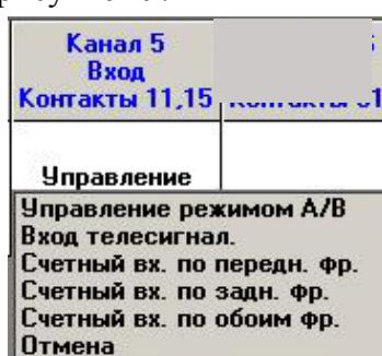
Рисунок 29 - Конфигурирование цифровых входов
