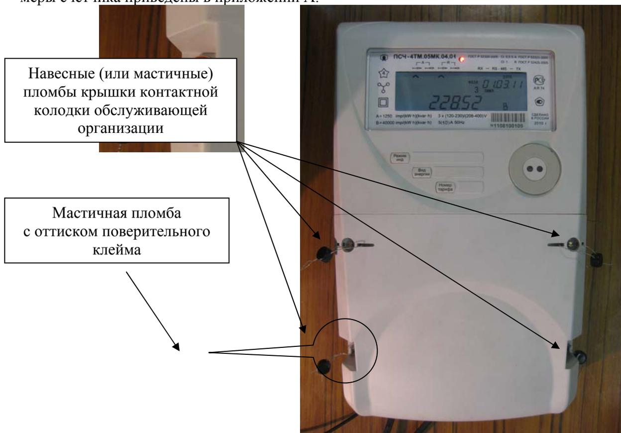
Рисунок 1 - Внешний вид счетчика ПСЧ-4ТМ.05МК
