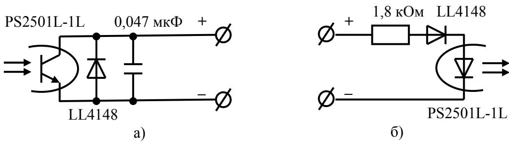
Рисунок В.9 - Фрагменты схемы испытательного выхода (а) и цифрового входа (б)
